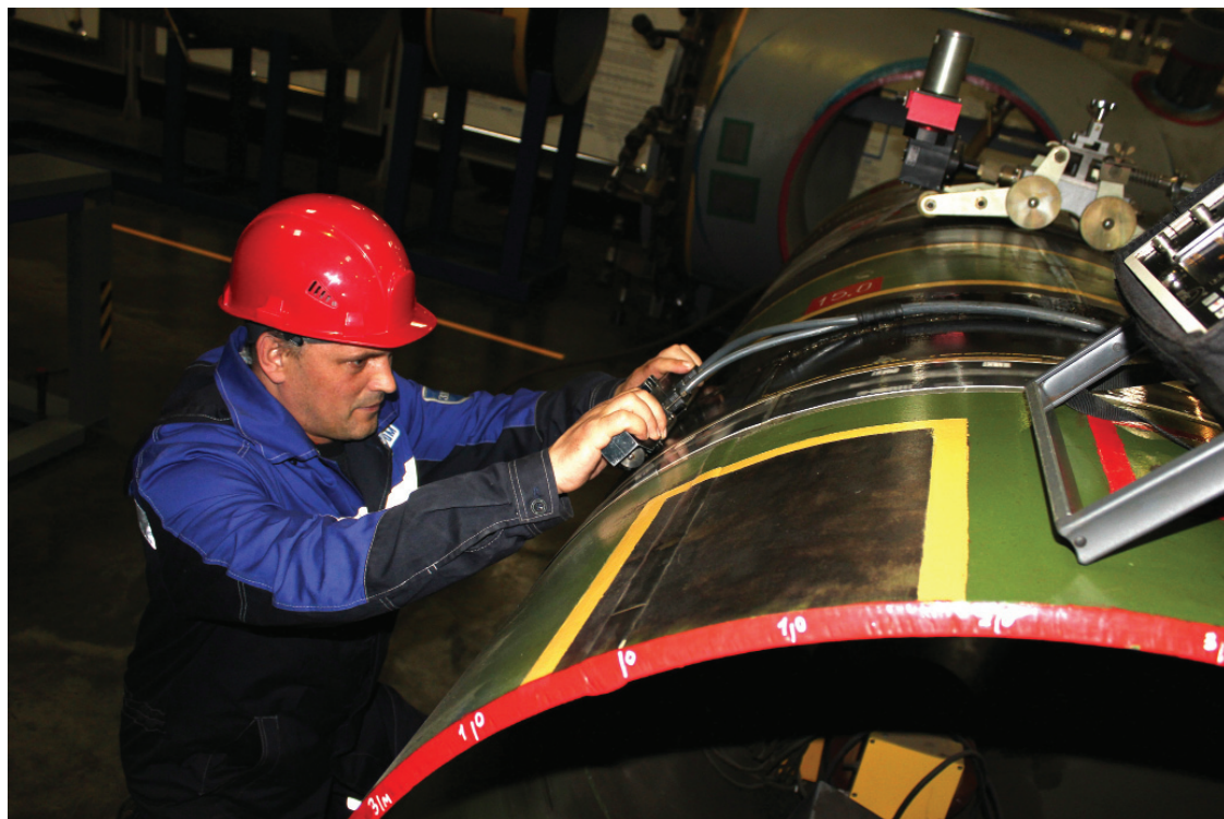
Дефектоскопист рентгеномагграфирования 6 разряда Дмитрий Краснов в момент настройки ультразвуковой измерительной установки «СКАНЕР»
