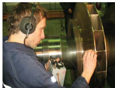
Инженер I категории ЛКДО Вячеслав Полянский проводит дефектоскопию ротора ЦБН, вихретоковый контроль рабочих колёс ротора намотателя ГПА-25/76Дн
