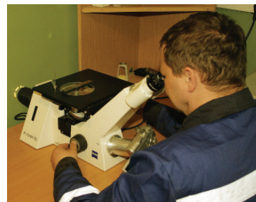
Инженер I категории ЛКДО Сергей Зямятин проводит микроструктурный анализ фрагмента сварного соединения трубопровода
