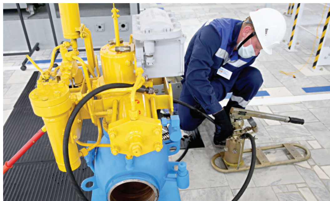
Конкурс машинистов технологических компрессоров. На фото слева – перестановка шарового крана аварийным комплектом, справа – техническое обслуживание шарового крана
