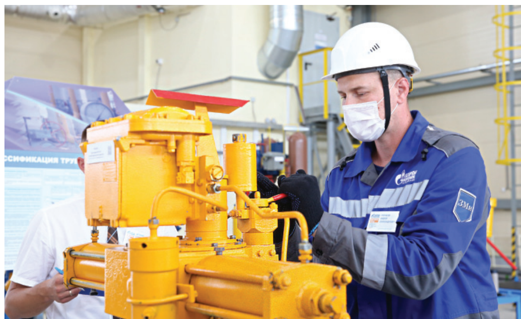
Конкурс машинистов технологических компрессоров. На фото слева – перестановка шарового крана аварийным комплектом, справа – техническое обслуживание шарового крана
