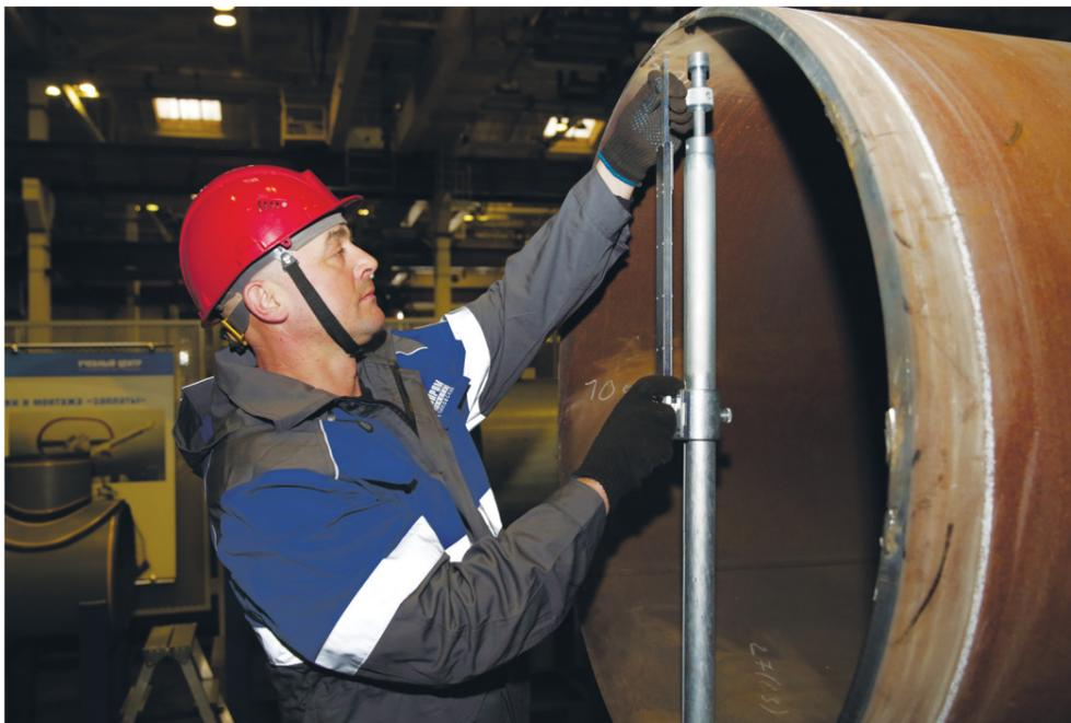
Установка центроискателя в торце трубы
